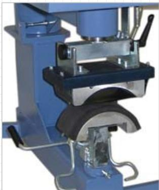
Die Kappen Option der TS 3P ist so aufgebaut, dass Sie auch für tief geschnittene Kappen gut funktioniert. Durch die Spannvorrichtung können die Kappen optimal zum Drucken gehalten und gespannt werden. Die Kappen-Vorrichtung für die TS 3P besteht aus einem Druckkopf und einer Spannvorrichtung.
