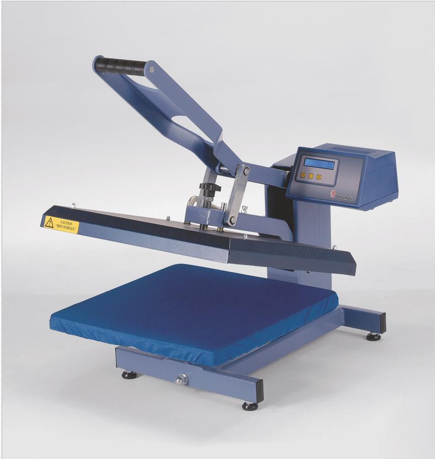
Die Druckregelung wird durch das Handrad voreingestellt. Der Druckvorgang wird von Hand durch das Betätigen des Hebels ausgelöst. Die digitale Anzeige zeigt die Temperatur, die Presszeit und die Anzahl der noch zu verarbeitenden Teile an. Sie ist ausgestattet mit einem Nomex Überzug zur Schonung der Druckplatte.
