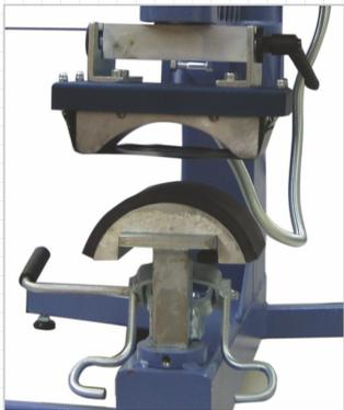
Die Kappen Option der TS 3M ist so aufgebaut, dass Sie auch für tief geschnittene Kappen gut funktioniert. Durch die Spannvorrichtung können die Kappen optimal zum Drucken gehalten und gespannt werden. Die Kappen-Vorrichtung für die TS 3M besteht aus einem Druckkopf und einer Spannvorrichtung.
