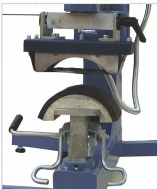
Die Kappen Option der TMH 28 ist so aufgebaut, dass Sie auch für tief geschnittene Kappen gut funktioniert. Durch die Spannvorrichtung können die Kappen optimal zum Drucken gehalten und gespannt werden. Die Kappen-Vorrichtung für die TMH 28 besteht aus einem Druckkopf und einer Spannvorrichtung.
