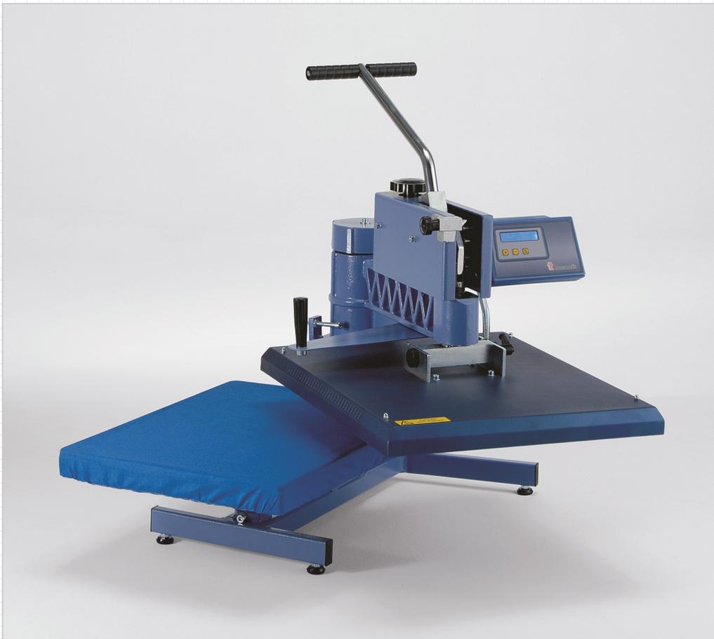
Die Druckregelung wird durch das Handrad voreingestellt. Der Druckvorgang wird von Hand durch das Betätigen des Hebels ausgelöst. Die digitale Anzeige zeigt die Temperatur, die Presszeit und die Anzahl der noch zu verarbeitenden Teile an. Sie ist ausgestattet mit einem Nomex Überzug zur Schonung der Druckplatte.
