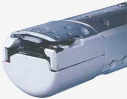
Unser einmaliger Zylinderarm sorgt für eine glatte, gleichmässige Oberfläche für unschlagbare Stickereien auf Kappen, wobei die Stickplatten zwischen Aufträgen nicht gewechselt werden müssen.
