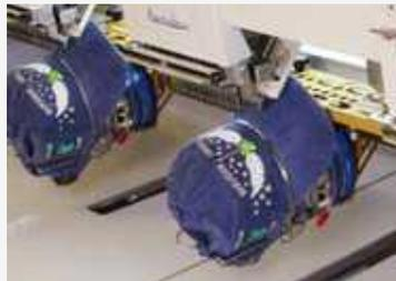
Rüsten Sie in wenigen Minuten von Mützen- auf Freiarmstickerei. Keine Werkzeuge sind notwendig, keine Nadelplatten müssen ausgetauscht werden. Weder der Pantograph noch der Rahmen müssen angepasst werden.
